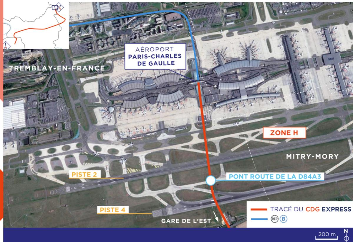
Le tracé du CDG Express arrive sur la plateforme aéroportuaire en passant sous la route périphérique sud au niveau d'une travée du pont route existant au niveau de la LGV Interconnexions.
