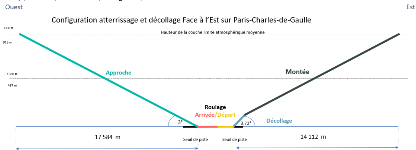
Figure 4 : Exemple pour un cycle LTO en configuration d'atterrissage et décollage face à l'Est à Paris-Charles-de-Gaulle.
