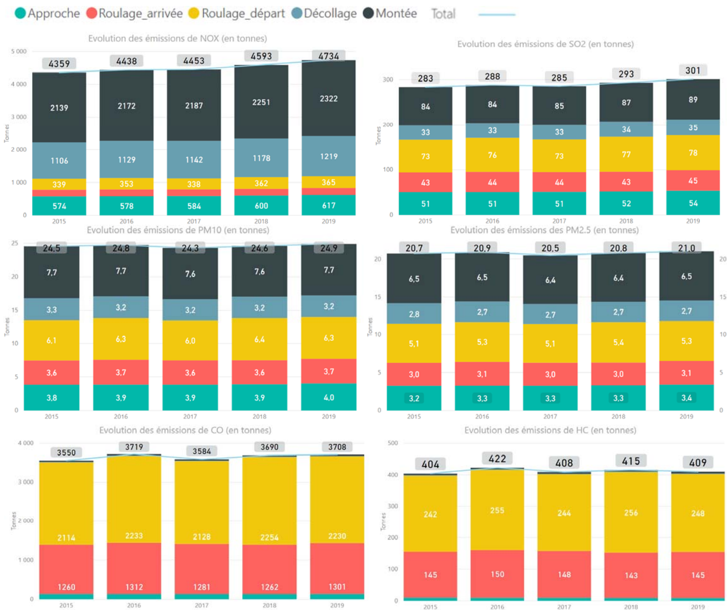
Figure 5 : Evolution des émissions par polluant (HC, NO x , CO, PM 10 , PM 2.5 ) détaillée par phase du cycle LTO à Paris-Charles de Gaulle
