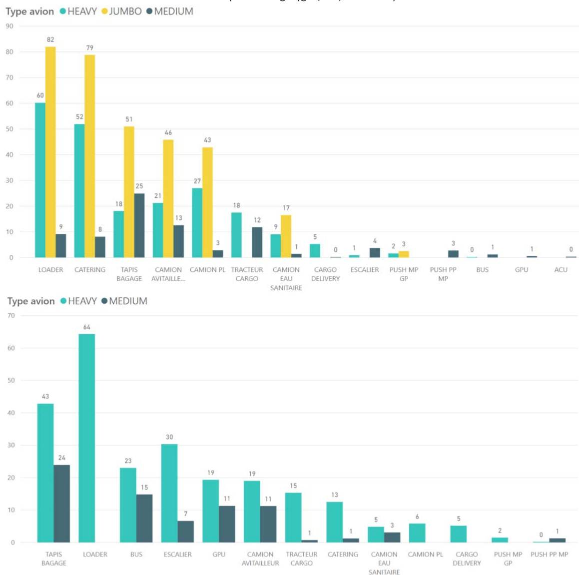
Figure 24: Temps moyens observés, par famille de GSE en fonction du type avion pour les postes au contact (graphique du haut) et au large (graphique du bas)
