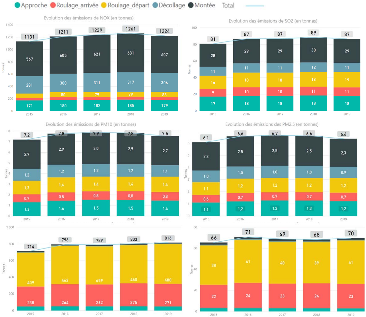
Figure 7 : Evolution des émissions par polluant (HC, NO x , CO, PM 10 , PM 2.5 ) détaillée par phase du cycle LTO à Paris-Orly
