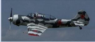
Variante du Yak 52, le Yak 52 TD a un train classique et l'hélice Bipale est remplacée par une tripale. De même des réservoirs supplémentaires sont rajoutés vers l'extérieur des ailes, avec une capacité d'emport de carburant supérieure.
