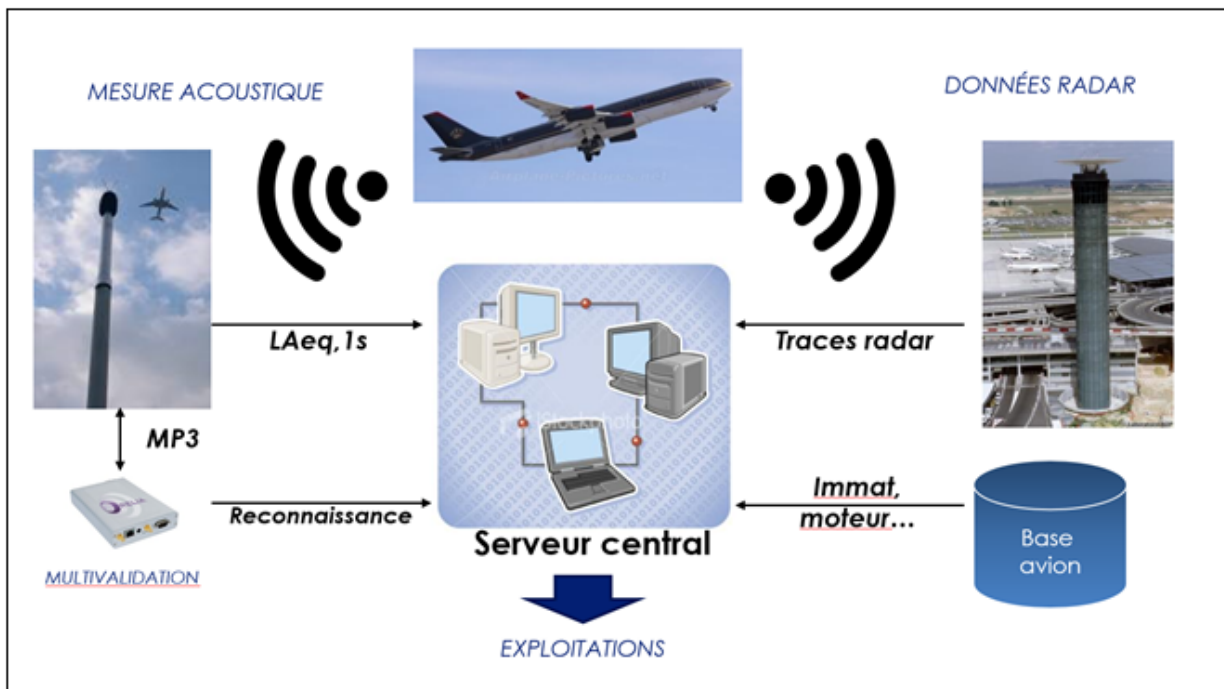
Figure 1 : Schéma de fonctionnement du système intégré de mesure du bruit et de suivi des trajectoires des avions
