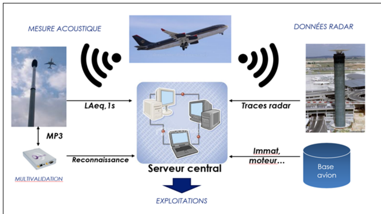
Figure 3 : Schéma de fonctionnement du système intégré de mesure du bruit et de suivi des trajectoires des avions
