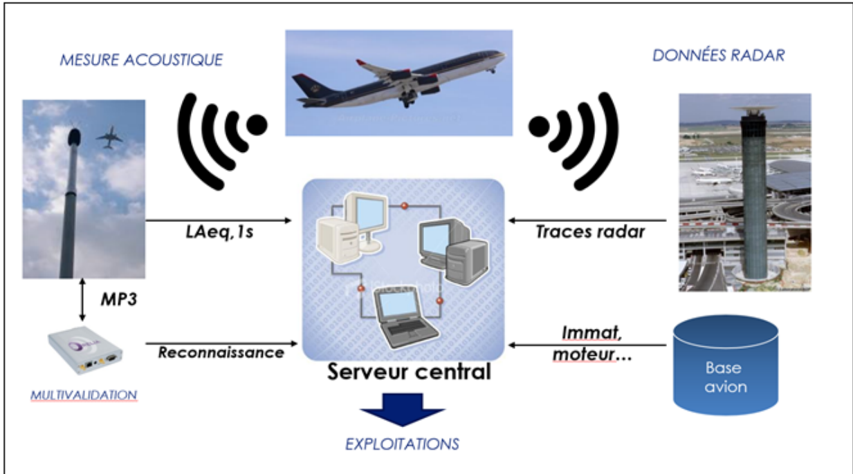
Figure 1 : Schéma de fonctionnement du système intégré de mesure du bruit et de suivi des trajectoires des avions
