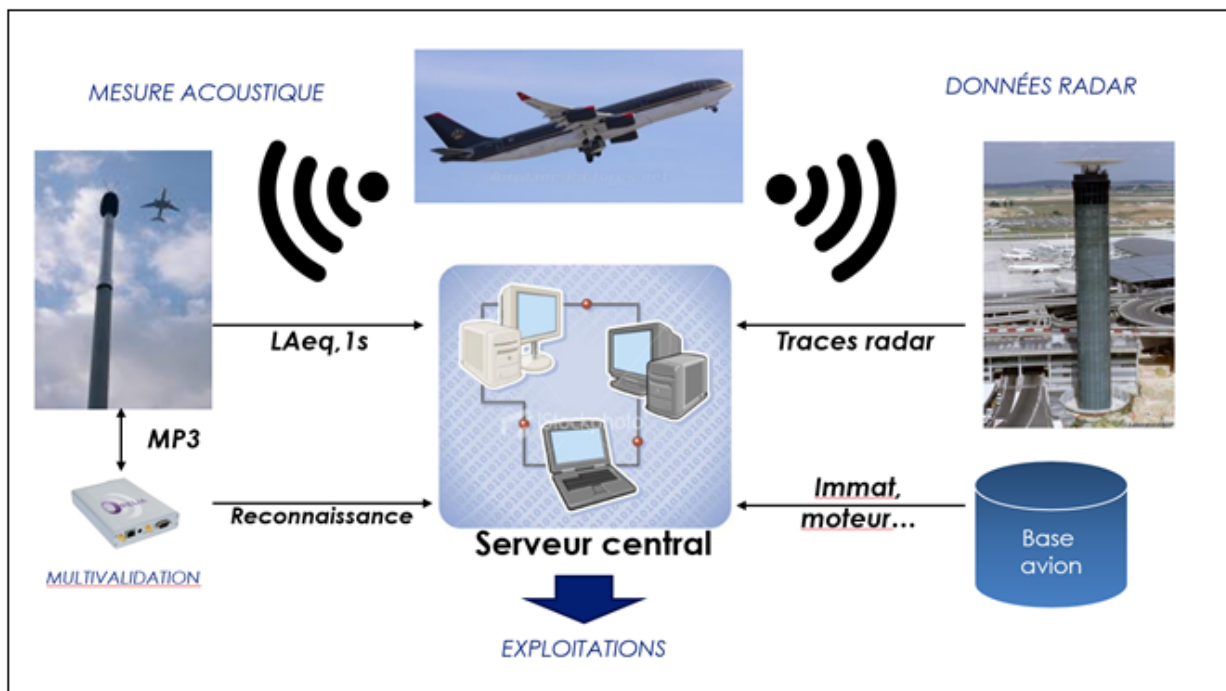
Figure 3 : Schéma de fonctionnement du système intégré de mesure du bruit et de suivi des trajectoires des avions
